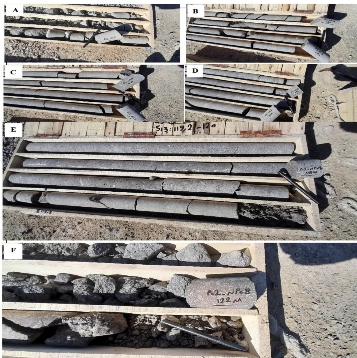
شکل ۵. توالی لیتولوژی در گمانه P02-NP08 معدن نسیم. A: سیلتستون، B: سنگ آهک، C: سنگ آهک، D: میکرو کنگلومرا، E: میکرو کنگلومرا (کانه دار) و F: آندزیت
