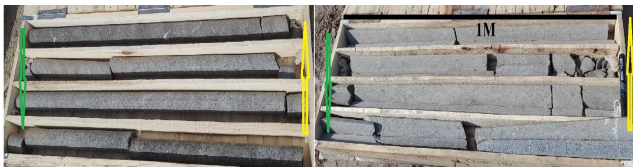
شکل ۱۴. تغییرات در کنگلومرا کمربند بردسکن درونه: کاهش اندازه و تعداد قطعه‌های آتشفشانی، افزایش سیمان کربناته (فلش زرد) - افزایش عیار (فلش سبز)
