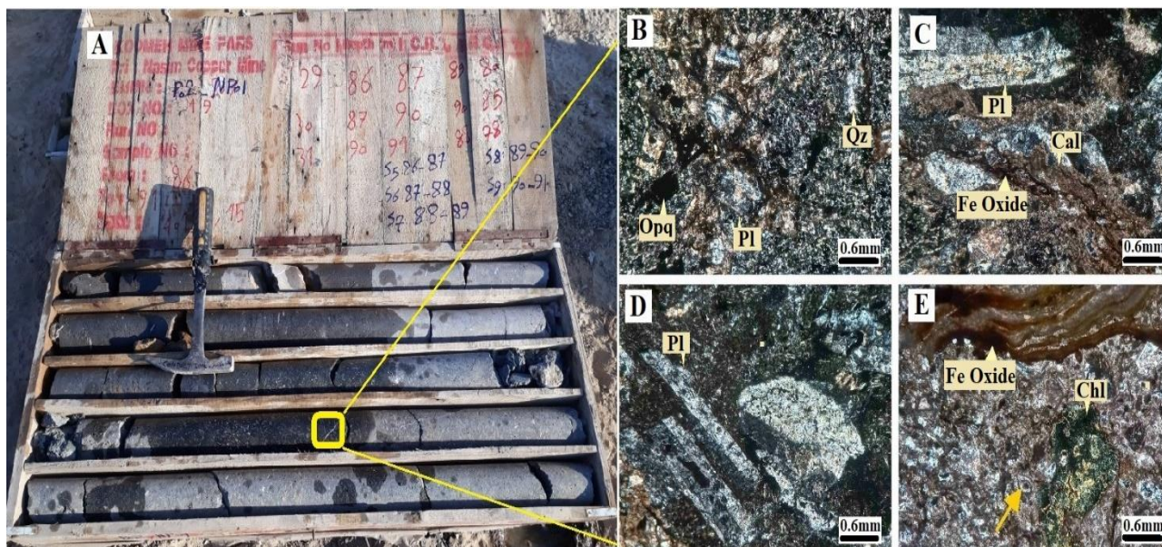
شکل ۱۲. A: جعبه مغزه حاوی کنگلومرای کانه‌دار - معدن نسیم، B: کانی‌های کوارتز، کانی کدر و پلاژیوکلاز (XPL)، C: بلورهای پلاژیوکلاز همراه با رگچه کربنات و اکسید آهن (XPL)، D: تصویر بلورهای شکل‌دار پلاژیوکلاز (XPL) و E: نمایی از رگچه‌های حاوی اکسید آهن همراه با کلریت و فسیل (فلش زرد رنگ) (XPL). علائم اختصاری کانی‌ها از ویتنی و اوانز (Whitney and Evans, 2010) اقتباس شده است (Pl: پلاژیوکلاز، Hbl: هورنبلند، Qz: کوارتز، Cal: کلسیت، Chl: کلریت، Opq: کانی کدر).
