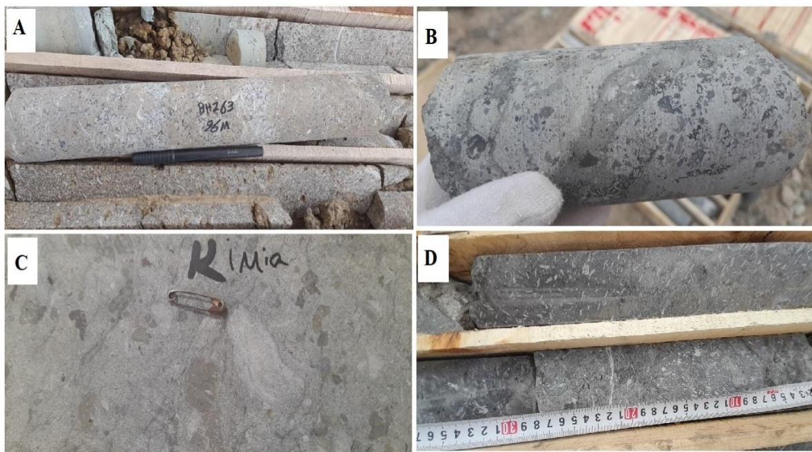
شکل ۹. کنگلومرا در چند کانسار مختلف به صورت مغزه. A: کنگلومرا در کانسار زرمهر، B: کنگلومرا در کانسار نسیم، C: کنگلومرا در کانسار کیمیا و D: کنگلومرا در کانسار مس سرخ
