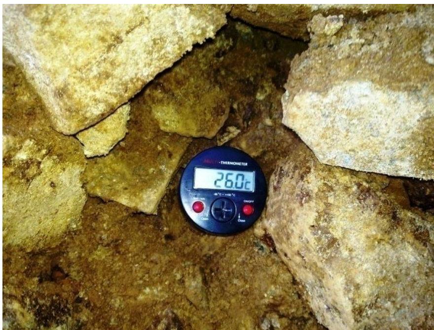
شکل 2. شارش هوای گرم و مرطوب از میان سنگهای ترانشه B در عمق 3 متری (دمای محیط 8 درجه سانتی‌گراد)
