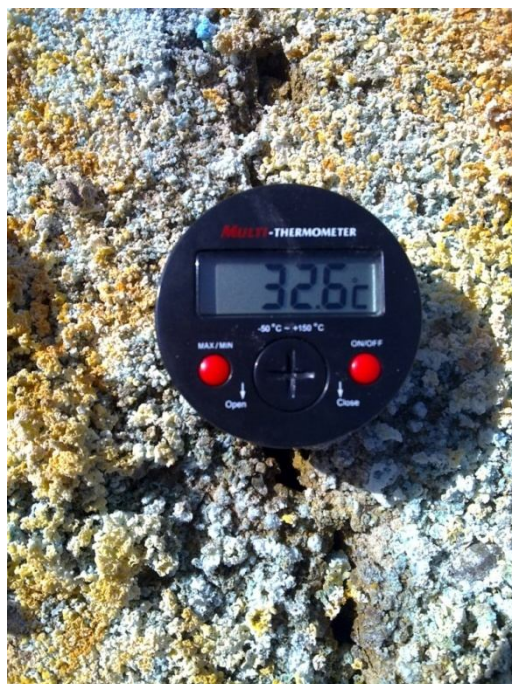
شکل 7. مجرای هوای گرم و مرطوب مشاهده شده در سطح کومه 19 که با تشکیل کانیه‌های ثانویه ملانتریت (کانیه‌های آبی رنگ) و رزونیت (کانیه‌های سفید رنگ) و اکسیدهای آهن (کانیه‌های نارنجی رنگ) همراه شده است
