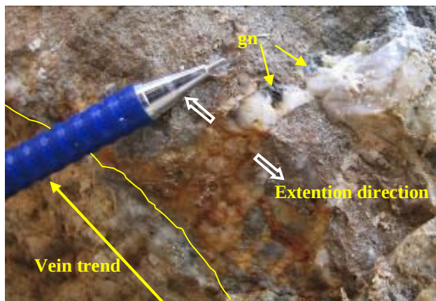
شکل 16. نمایی از رگه سیلیسی زون استرینگر که در اثر عملکرد دگرشکلی نوع شکنا توسط مجموعه ای از رگچه‌های سیلیسی با راستای عمود بر روند رگه سیلیسی میزبان قطع شده‌اند. رگچه‌های سیلیسی قطع کننده، در اثر کشش حاصل از دگرشکلی تشکیل شده و معمولاً با گالن (gn) همراه هستند.
