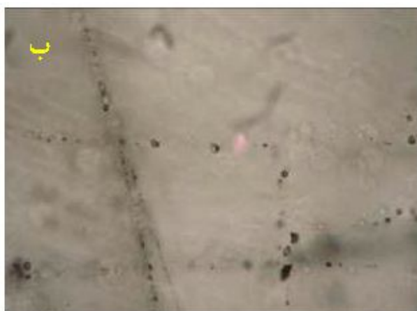
شکل 8: الف) سیال درگیر اولیه دو فازه و ب) سیالات درگیر ثانویه در کوارتزهای مربوط به رگه‌های سیلیسی زون استرینگر. L=Liquid, V=Vapor.
