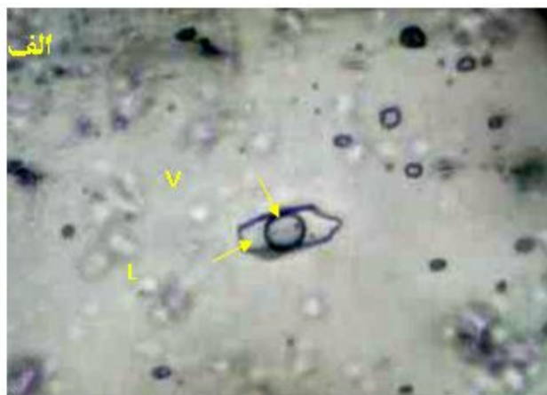
شکل 8: الف) سیال درگیر اولیه دو فازه و ب) سیالات درگیر ثانویه در کوارتزهای مربوط به رگه‌های سیلیسی زون استرینگر. L=Liquid, V=Vapor.
