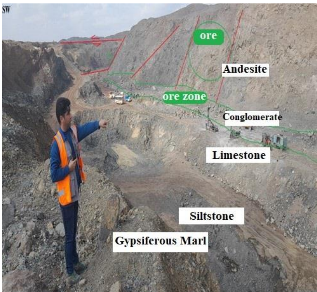
شکل ۵. واحدهای سنگ شناختی، روند ماده معدنی و ساختارهای زمین ساختی در پیت در حال استخراج معدن نسیم
