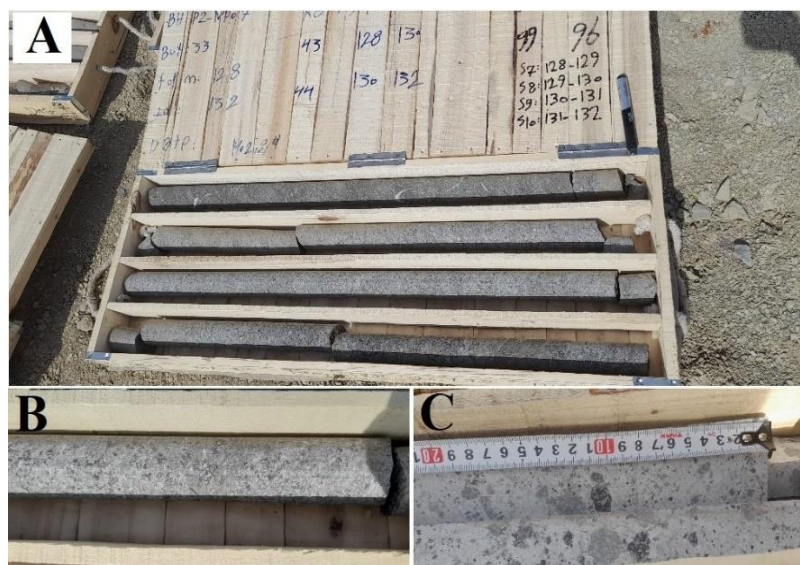
شکل ۹. A: جعبه مغزه حاوی سنگ آهک و کنگلومرا- کانسار نسیم، B و C: نمایی از همان سنگ میزبان به صورت مغزه
