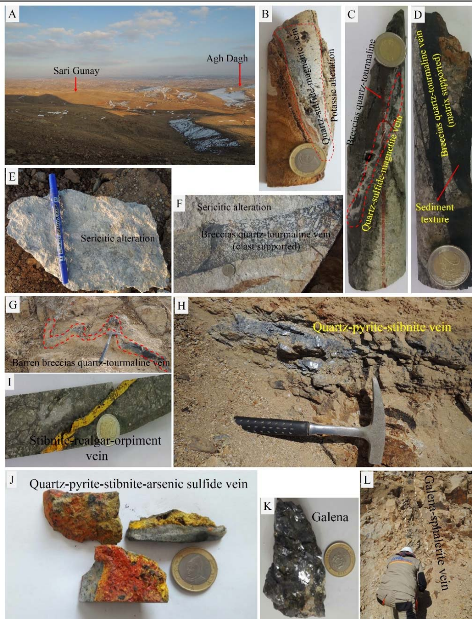
شکل ۳. A: موقعیت مناطق معدنی ساری گونی و آق‌داغ (دید به سمت شمال)، B: رگه‌های کوارتز-سولفید-مگنتیت اولیه، C: برش‌های کوارتز-تورمالین رگه‌های کوارتز-سولفید-مگنتیت اولیه را قطع کرده است، D: رگه‌ها و برش‌های کوارتز-تورمالین با سیمان غالب دارای بافت رسوبی در حاشیه رگه، E: نمونه دستی دگرسانی سریستی همراه با برش‌های کوارتز-تورمالین، F: رگه‌ها و برش‌های کوارتز-تورمالین با قطعات غالب در سنگ میزبان داسیتی، G: رگه‌ها و برش‌های کوارتز-تورمالین عقیم، H: رگه‌های کوارتز-پیریت-استینیت، I و J: رگه‌های کوارتز-پیریت-استینیت-رالگار-اورپیمت، K: نمونه دستی گالن و L: رگه‌های کوارتز-کلسیت-پیریت-گالن-اسفالریت حاوی اذخال‌های تتراهدريت
