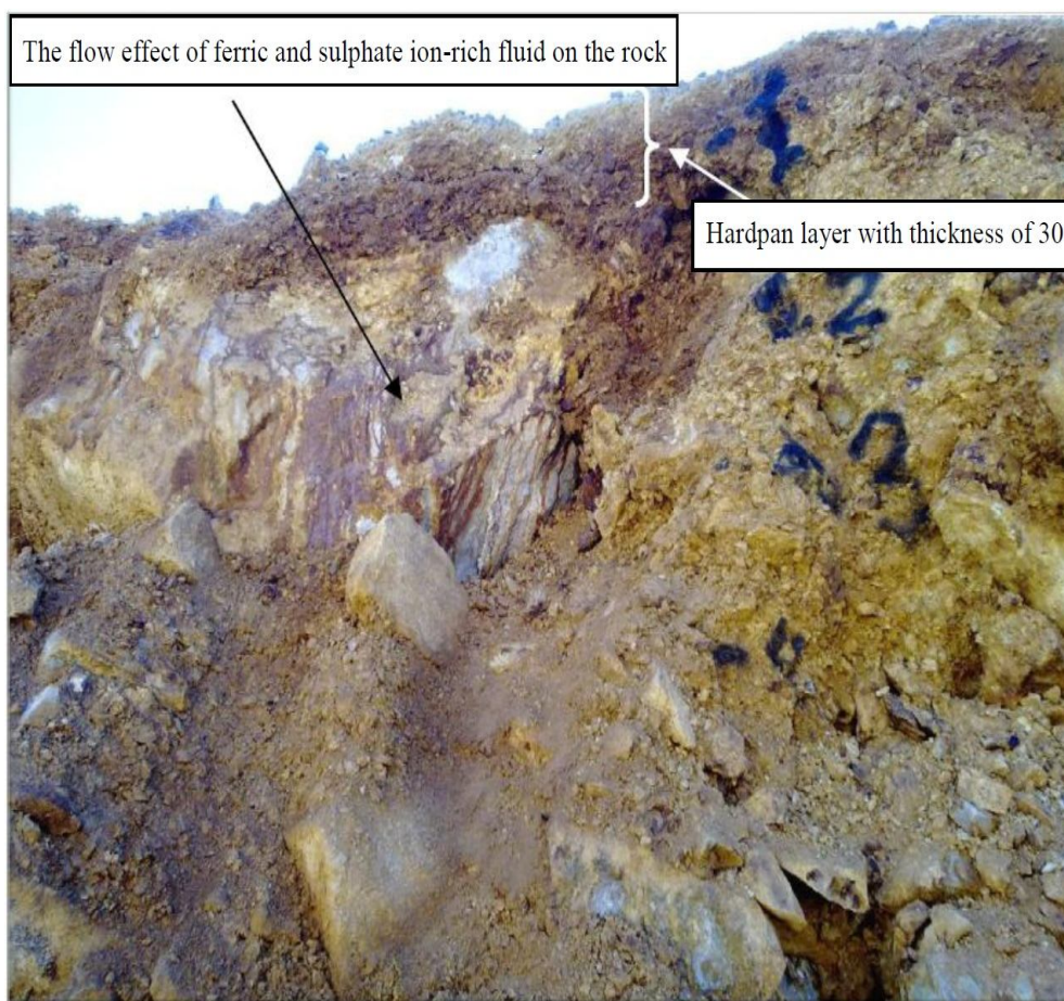
شکل 8. لایه هاردپن و اثر جریان مایعات غنی از یون آهن و سولفات در ترانشه A
