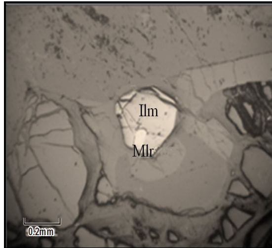
شکل 5. همراهی کانیه‌های ایلمنیت (Ilm) و میلریت (Mlr) در سنگ مادر الیوین گابروی منطقه فنوج (نور پلاریزه انعکاسی ساده).
