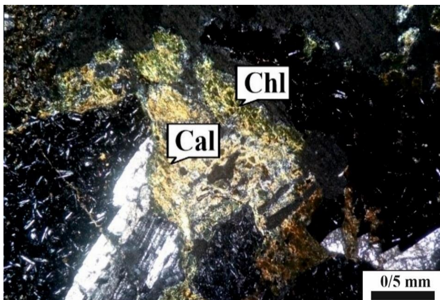
شکل ۱۲. تصویر میکروسکوپی از دگرسانی کلریت و کلسیت به صورت فراگیر در زمینه واحد آندزیتی در کانسار مس نسیم (در نور XPL). علایم اختصاری از ویتنی و اوانز (Whitney and Evans, 2010) اقتباس شده است (Chl: کلریت، Cal: کلسیت).
