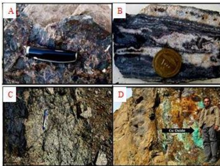
شکل 17. حالت‌های مختلف کانی‌سازی در کانی‌زایی آهن رشتخوار، A: برش هیدروترمالی، B: لایه‌ای - شانه‌ای، C: استوکورکی و D: کانی‌زایی کربنات‌های مس (آزوریت و مالاکیت) همراه با کانی‌زایی آهن در منطقه
