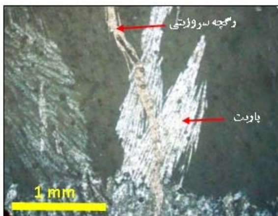
شکل ۹. باریت با بافت دم جارویی
