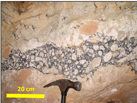
شکل ۲۰. برشهای چرخیده و گرده شده سیمان شده با ماده معدنی.
