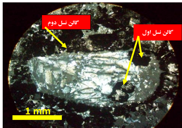
شکل ۲۱. بافت کوکاد حاصل از ته نشینی نازک لایه گالن بر روی قطعه خرد شده از بافت اولیه قشری
