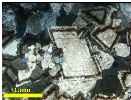
شکل ۱۱. دولومیت نوع سوم درشت بلور و با حاشیه تیره.
